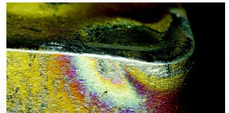
高い切削熱による塑性変形
