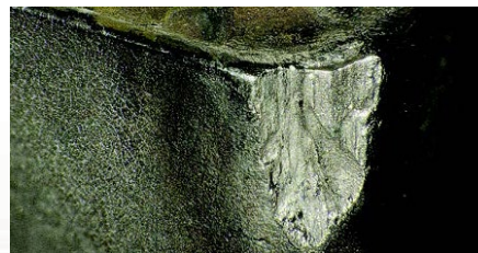
溶着チッピングを起因とした欠損
