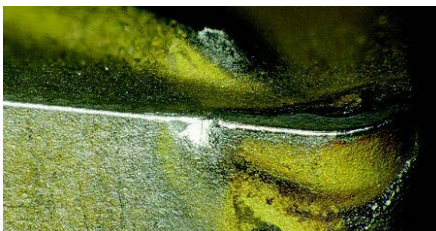
切り込み境界部の損傷
