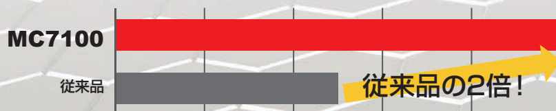
\text{Al}_2\text{O}_3 被膜結晶粒内の同じ方位を示す結晶粒割合
