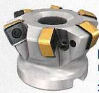
FFQ8 高送り加工用 リード角12° 最大切込み深さ 1.5mm
