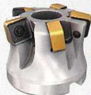
FFQ8 高送り加工用 リード角12° 最大切込み深さ 1.5mm
